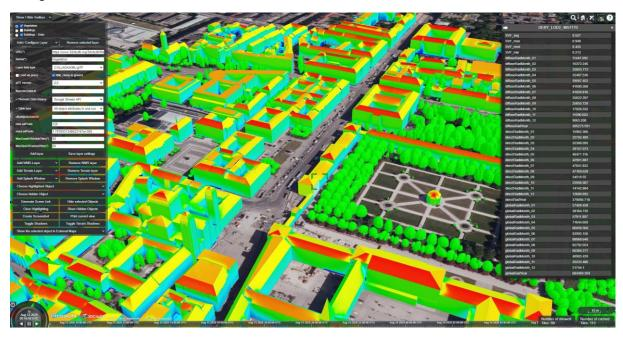
Abb. 3: Visualisierung des Vegetationsmodells und der Ergebnisse der Solarpotentialanalyse im 3D-CityDB-Webclients vom Münchner Odeonsplatz mit Blick Richtung Norden: Die solare Einstrahlung ist als Textur auf den LoD2-Gebäuden über eine Farbskala von blau (wenig Einstrahlung) bis rot (viel Einstrahlung) dargestellt. Links im Bild ist das Funktionsmenü zu sehen, rechts ist die Tabelle mit den generischen Attributen zur solaren Einstrahlung des ausgewählten Gebäudes eingeblendet.
