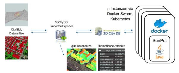
Abb. 1: Workflow der Solarpotentialanalyse: Alle Datensätze werden in eine 3DCityDB Instanz importiert. Das Simulationstool bezieht die benötigten Daten aus dieser DB und legt die Ergebnisse dort ab. Anschließend können die Ergebnisse als CSV, CityGML-Datei, oder in verschiedene Visualisierungsformaten (kml, gITF) exportiert werden.
