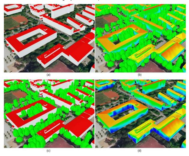
Abb. 2: Darstellung der Ergebnisse der Grünmodellierung und der Solarpotentialanalyse im 3D-Webclient. Bild (a) zeigt das LoD2-Gebäudemodell ohne Texturen, Bild (b) zeigt das Gebäudemodell Solartexturen (blau bis rot = wenig bis viel solare Einstrahlung) und Vegetation, Bild (c) zeigt das untexturierte Gebäudemodell mit Vegetation. Bild (d) zeigt das Gebäudemodell mit Solartexturen bei ausgeblendeter Vegetation. Die von der Vegetation verschatteten Fassadenbereich sind deutlich zu erkennen.
