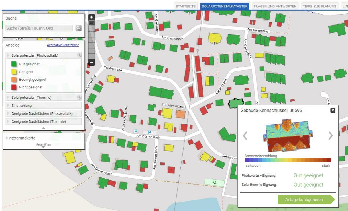
Abb. 2: Eignungsklassifizierung mit verschiedenen Stufen (Karte) und Einstrahlungsgrafik mit farblicher Abstufung der Kilowattstunden pro Quadratmeter pro Jahr, Rot = stark, Blau = schwach (Pop-up unten rechts)
