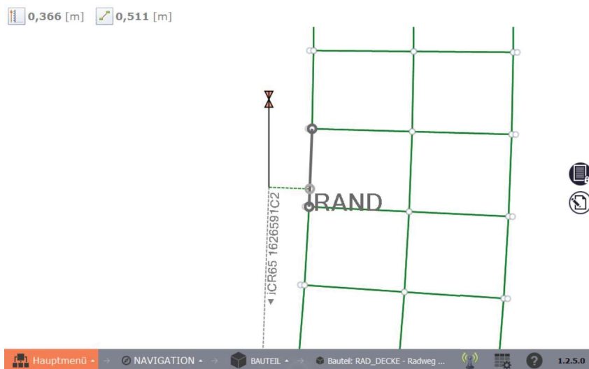
Abb. 3.1.12-3: Screenshot der Navigation, der die Anwendung nach der Selektion „Radweg Decke“ und „Linien“ zeigt. Dem Anwender wird dynamisch der aktuelle rechtwinklige Abstand (0,366 m) und die Höhendifferenz (0,511 m) zum Rand angezeigt.
